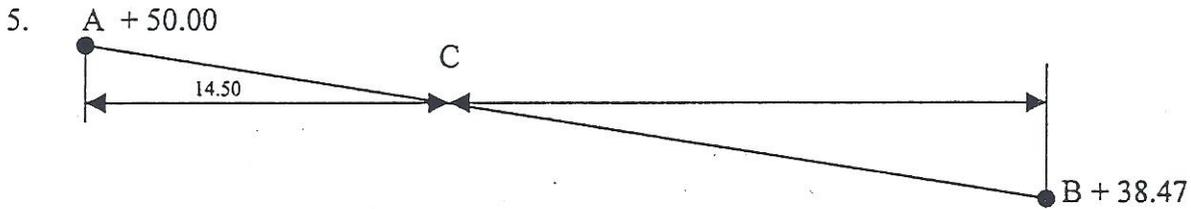
Berechne die Geländehöhe bei C
