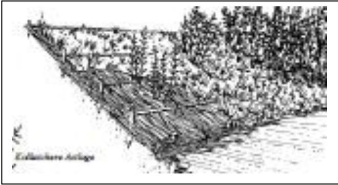
Auslegen von ausschlagfähigen Weidenästen, leicht überdecken mit Unter- oder Oberboden. Fixieren der Äste mit Pfählen und Drähten
