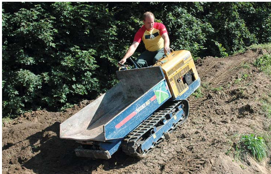
In Hanglagen sind Maschinen besonders vorsichtig zu bewegen. Um genügend Reserven zu haben, sollte die maximale Nutzlast nicht ausgeschöpft werden.
